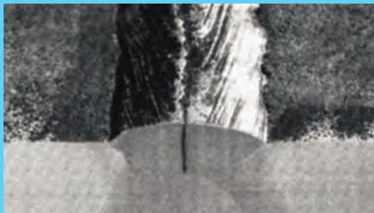
ترک طولی در خط مرکزی یک جوش شیاری
