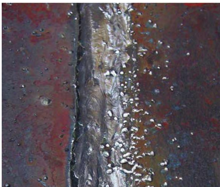
شکل ۱۲-۱۷- نمونه‌ای از پاشش جوش
