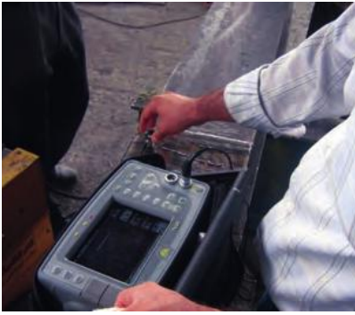
بازرس آزمایش فراصوتی در حال انجام آزمایش
