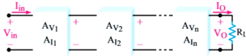
شکل (۱-۱۴): بلوک دیاگرام تقویت کننده n طبقه
