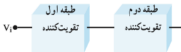
شکل (۱۴-۷): تقویت کننده دو طبقه با کوپلاژ به صورت مستقیم
